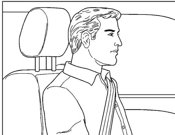
Régler l'appui-tête de sorte que sa partie supérieure arrive au niveau de la tête de l'occupant. Cette position réduit les risques de blessure à la nuque lors d'une collision.
