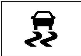
Si votre véhicule est équipé du système StabiliTrak<sup>MD</sup>, ce témoin s'allume lorsque le système StabiliTrak<sup>MD</sup> est désactivé.
