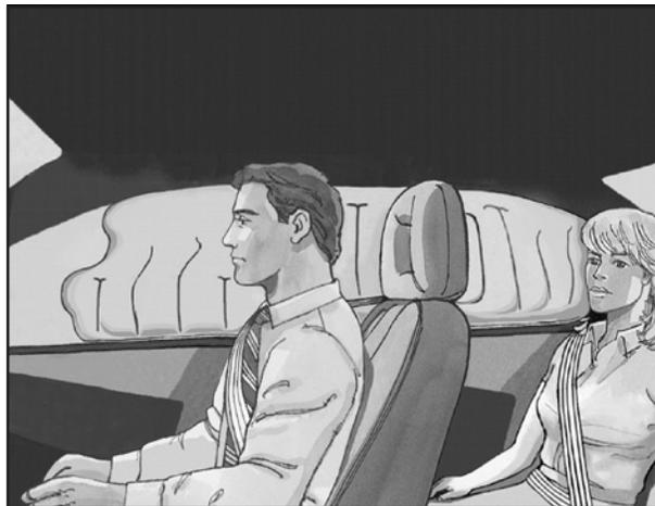
Si votre véhicule est équipé d'un sac gonflable de pavillon pour le passager avant droit et la personne directement derrière ce passager, celui-ci se trouve dans le plafond au dessus des vitres latérales.
