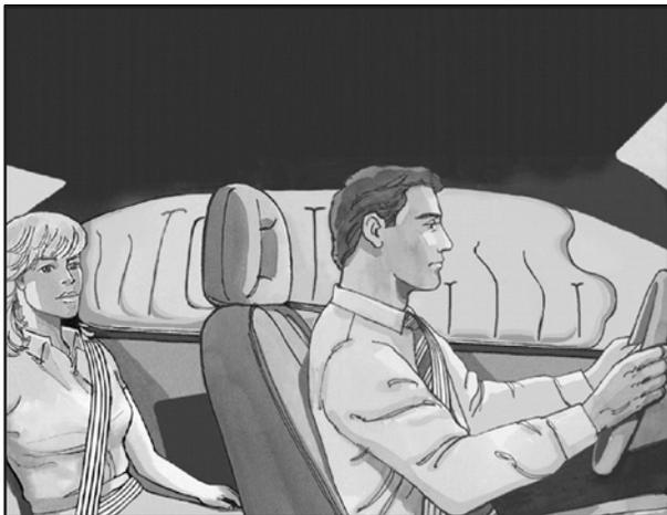
Si votre véhicule est équipé d'un sac gonflable latéral monté sur le toit pour le conducteur et le passager assis immédiatement derrière, ce sac se trouve au plafond, au-dessus des glaces latérales.
