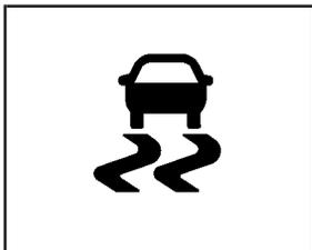
Ce témoin s'allume constamment lorsque le système de traction asservie est désactivé. Ce témoin clignote lorsque le système de traction asservie est activé.
