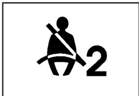
Ce carillon et ce témoin fonctionneront de nouveau si le passager ne boucle pas sa ceinture de sécurité et que le véhicule se déplace.
